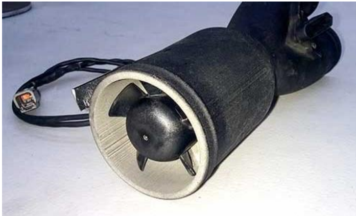
Obudowa wentylatora z zintegrowanym przełącznikiem. Konstrukcja została wydrukowana na wysokiej rozdzielczości drukarce SLS sPro 230 w materiale DuraForm®.
